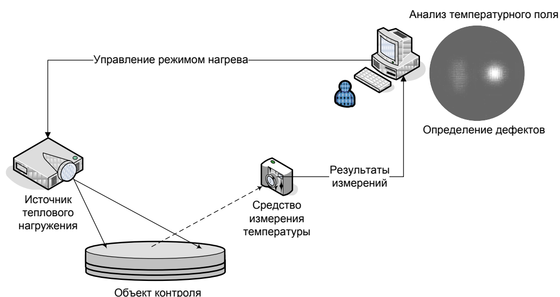
Рис. 1. Структура системы активного теплового контроля многослойных биметаллических пластин
