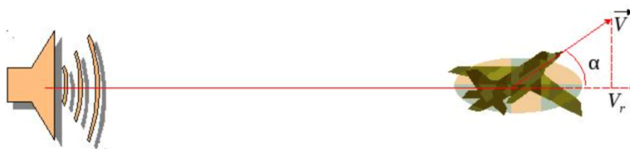
Рис. 2. Поправка к вычислению скорости с помощью доплеровского радара
